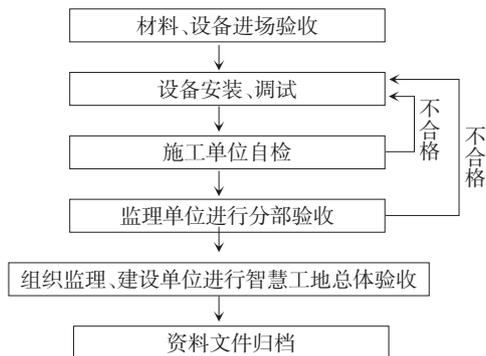
图 10.2.3 智慧工地质量检验与验收流程图
