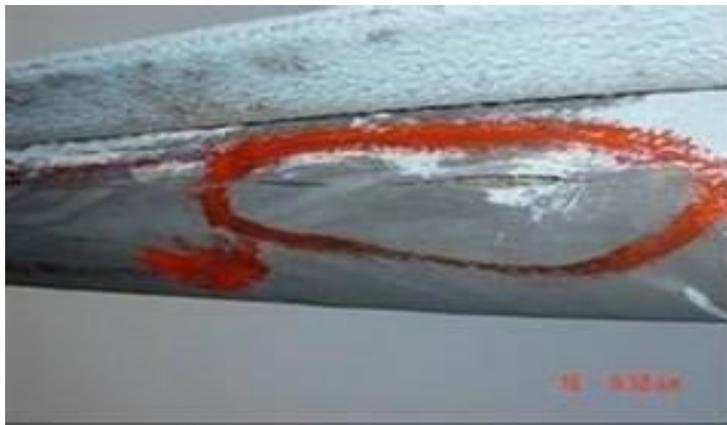
图 4.8-1 PE 护套开裂
