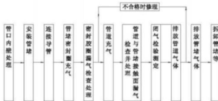
图 E. 1. 2 管道闭气试验工艺流程图
