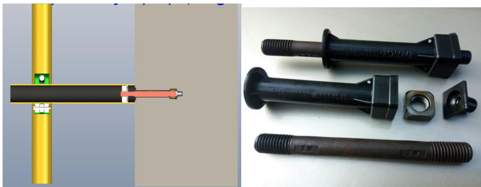
M14 双头螺纹螺栓杆示意图
